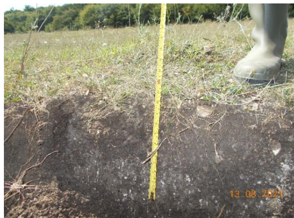
სურათი 8. ნაყოფიერი ფენის სიმძლავრეების გაზომვის ფოტო ილუსტრირება
