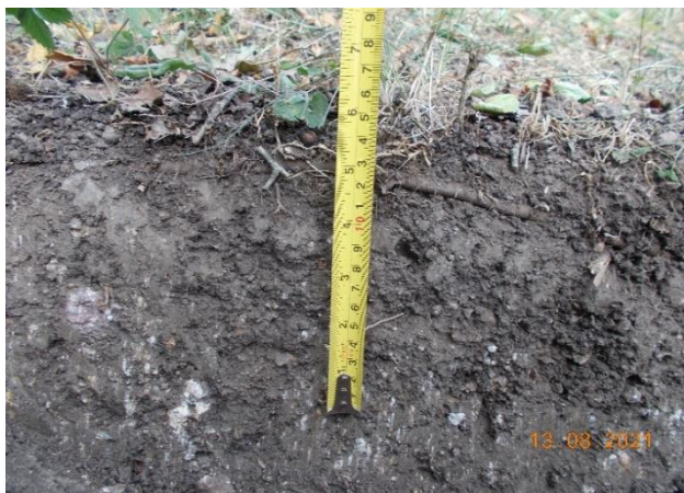
სურათი 8. ნაყოფიერი ფენის სიმძლავრეების გაზომვის ფოტო ილუსტრირება
